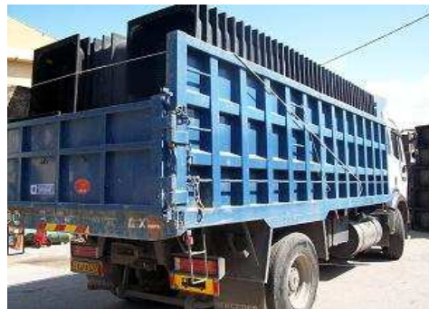
Εικόνα 2 :Σωστή φόρτωση με «χτιστό» ντάνιασμα και ασφαλές δέσιμο των πλαστικότύπων με ιμάντες ή σχοινιά.
