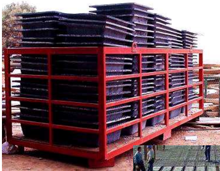
Εικόνες 4,5: Κιβώτιο και «κλούβα» μεταφοράς πλαστικότύπων με γερανό.
