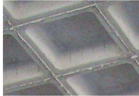
Εικόνα 14: Το γρέζι αφαιρείται εύκολα με σκεπάρνι ή σβουράκι.
